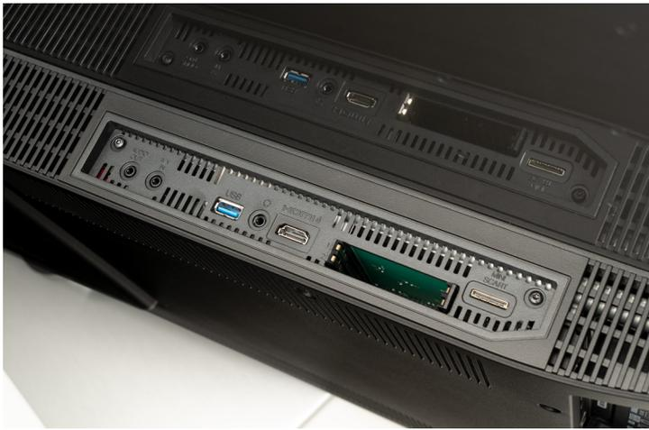
Im zweiten Anschlussfeld befinden sich u.a. der Kopfhörerausgang, ein zweiter USB-Steckplatz, die Scart-Mini-Buchse und der Einschub für zwei CI-Module.
