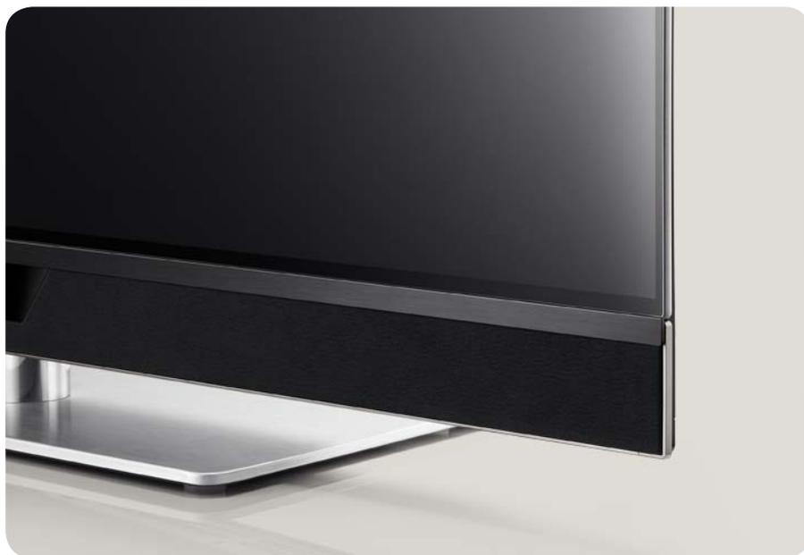
Der Lautsprecher ist eine regelrechte Soundbar mit sechs Treibern. Ein zusätzlicher Subwoofer ist im Korpus integriert, der bis 45 Hertz herunterreicht
