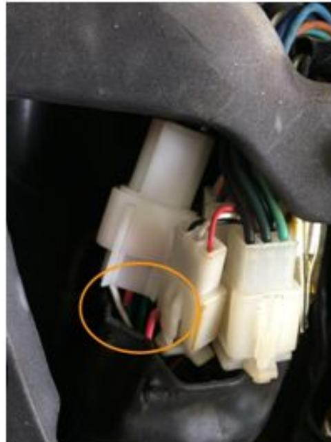
**5. Sicherstellen, dass das Signal-Aktivierungs-Kabel tatsächlich mit dem Akkustecker verbunden ist**
