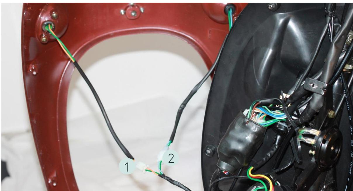
Dévisser les 2 vis cruciformes et retirer le clignotant gauche de la plaque frontale et le débrancher à [1].
