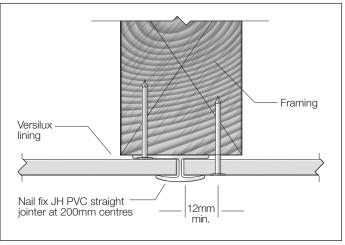
FIGURE 12 PVC STRAIGHT JOINT DETAIL
