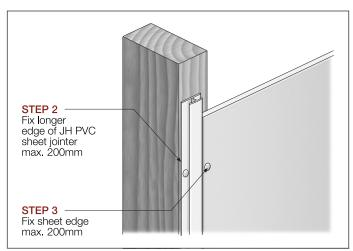
FIGURE 10 STEP 2 - FIX JOINTER
