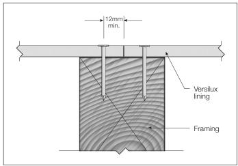
FIGURE 14 BUTT JOINTING DETAIL
