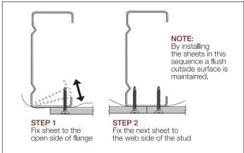
FIGURE 3 SCREW FASTENING
