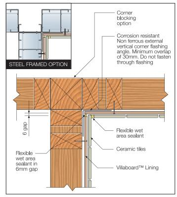
FIGURE 9 VERTICAL CORNER FLASHING FOR EXTERNAL MEMBRANE - SHOWER RECESS
