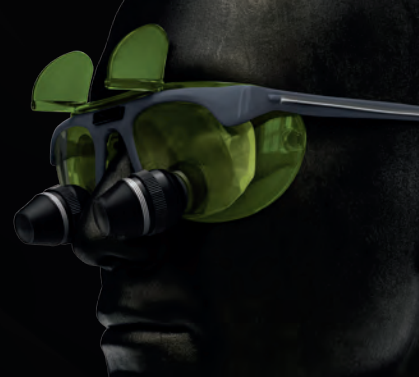
5842 - Multi-Wave OD 8+ @ 180-385nm OD 1+ @ 650 - <730nm OD 2+ @ 730 - <800nm OD 4+ @ 800 - <840nm OD 5+ @ 840 - <960nm OD 7+ @ 960 - 1400nm OD 4+ @ >1400 - <3000nm OD 6+ @ 10600nm
