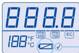
Crochet indiquant un étalonnage réussi
