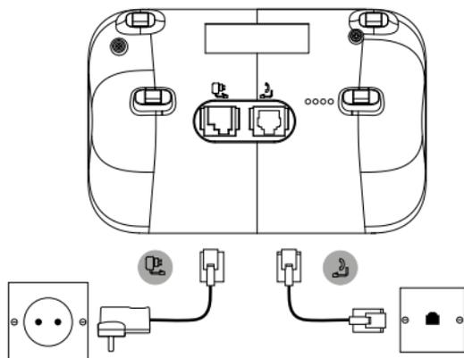
1. Schließen Sie das Telefonkabel an der Buchse
