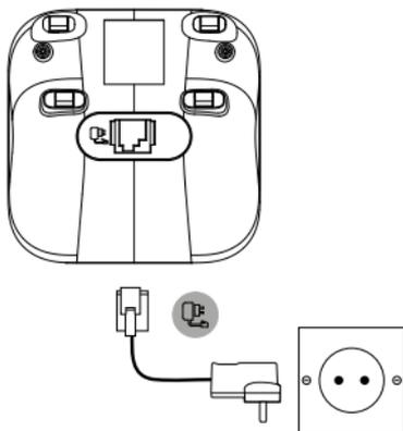
1. Schließen Sie das Netzteil an der Buchse
