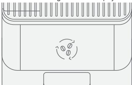
02. Entfernen des Kaffeebohnenbehälters: Entriegeln Sie den Knopf und drücken Sie die seitliche Entnahmetaste nach unten.
