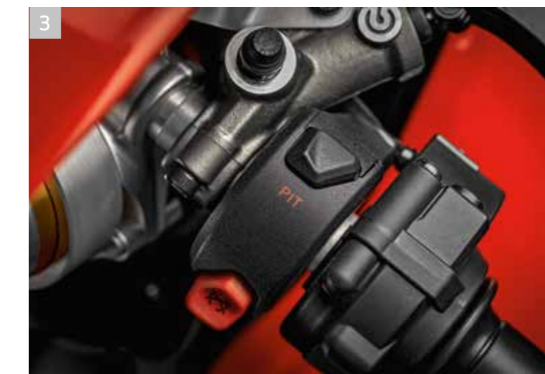
1 ブラシ仕上げアルミニウム製フェューエルタンク 2 オーリンズ製フルアジャスタブルTTX36ショック 3 ピット・リミッター起動スイッチ (PIT)
