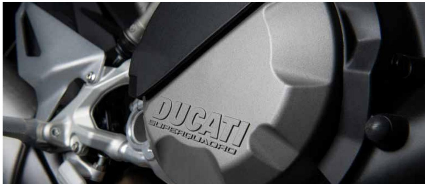
ストリートファイター V2に搭載されている955ccスーパーquadro2気筒エンジンは、153ps@10,750rpmの最高出力と101.4Nm@9,000rpmの最大トルクを発生し、パワフルでありながらも、そのパワーを持って余すことなく、公道で楽しくライディングすることができます。ユーロ5規制に適合したストリートファイターV2のエンジンは、パニガーレV2のユニットと共通のエグゾースト・システムを採用しています。コンパクトな
