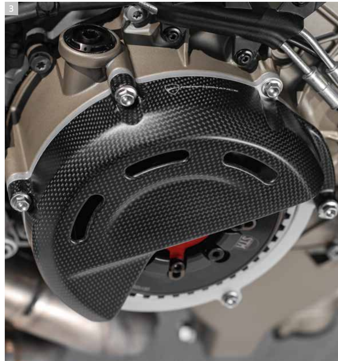
3 カーボンファイバー製乾式クラッチカバー
