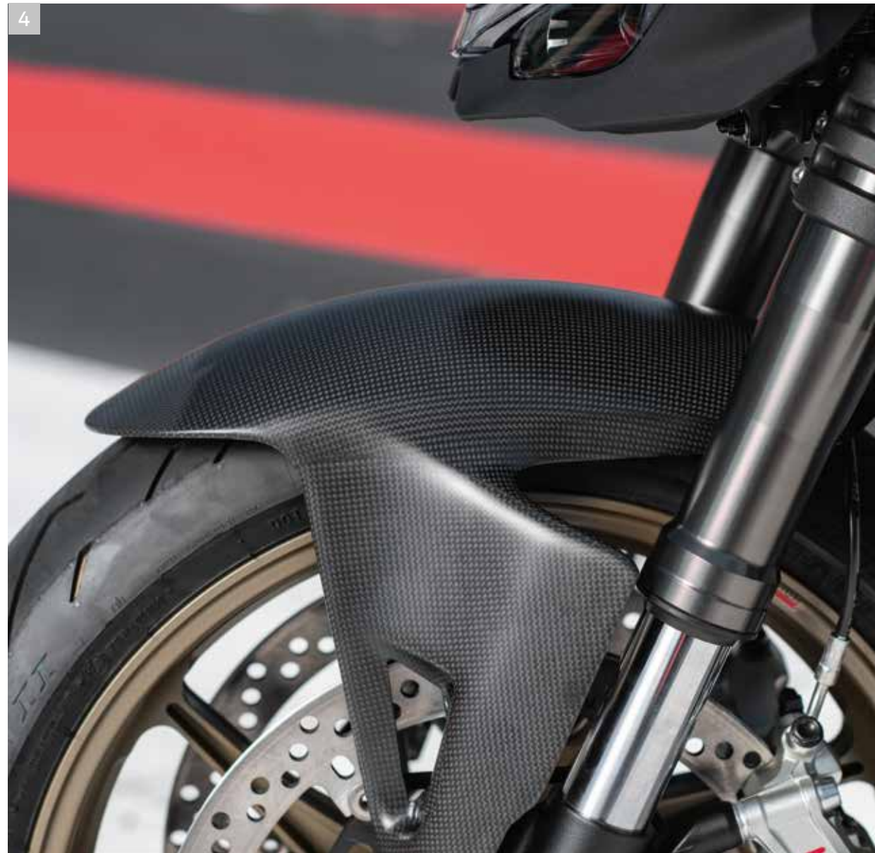
3 カーボンファイバー製リアフェンダー 4 カーボンファイバー製フロント・フェンダー
