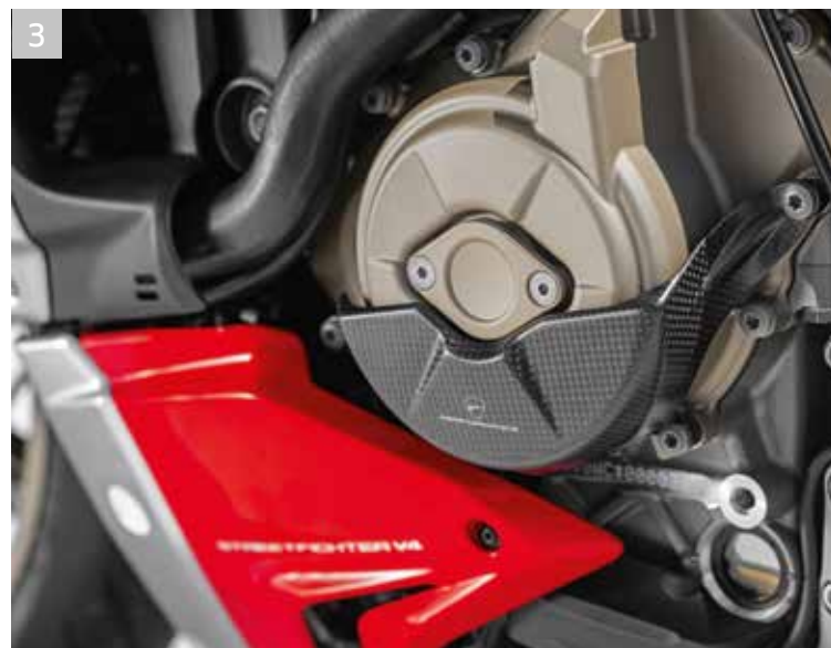
2 クラッチ&ブレーキ・フルード・リザーバー 3 カーボンファイバー製ジェネレーター・カバー・プロテクター
