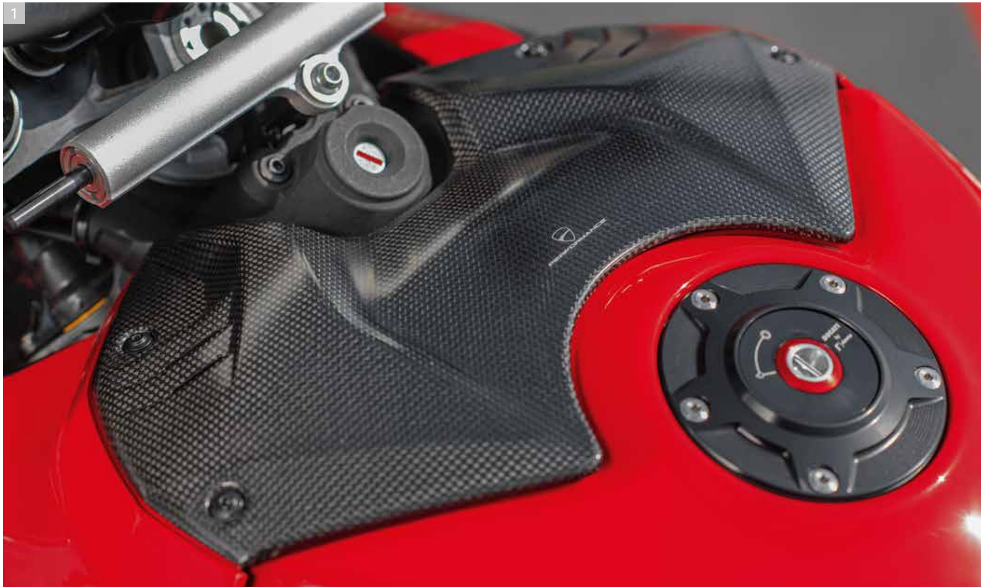
1 カーボンファイバー製タンクカバー ビレット・アルミニウム製タンクキャップ
