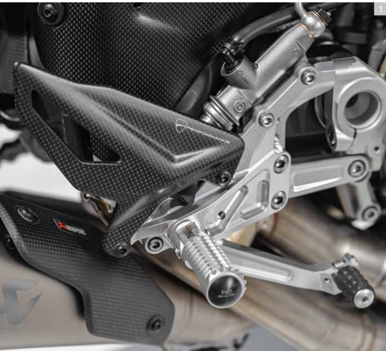
2 カーボンファイバー製ヒールガード アルミニウム製アジャスタブル・ライダー・フットペグ
