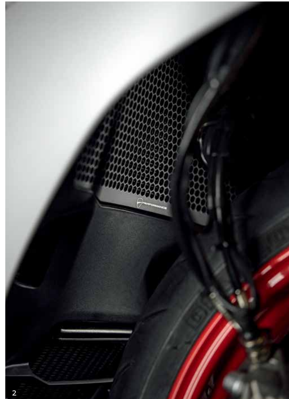
2_ ラジエーター用プロテクショングリッド。3_ アルミニウム製ナンバープレートホルダー。
