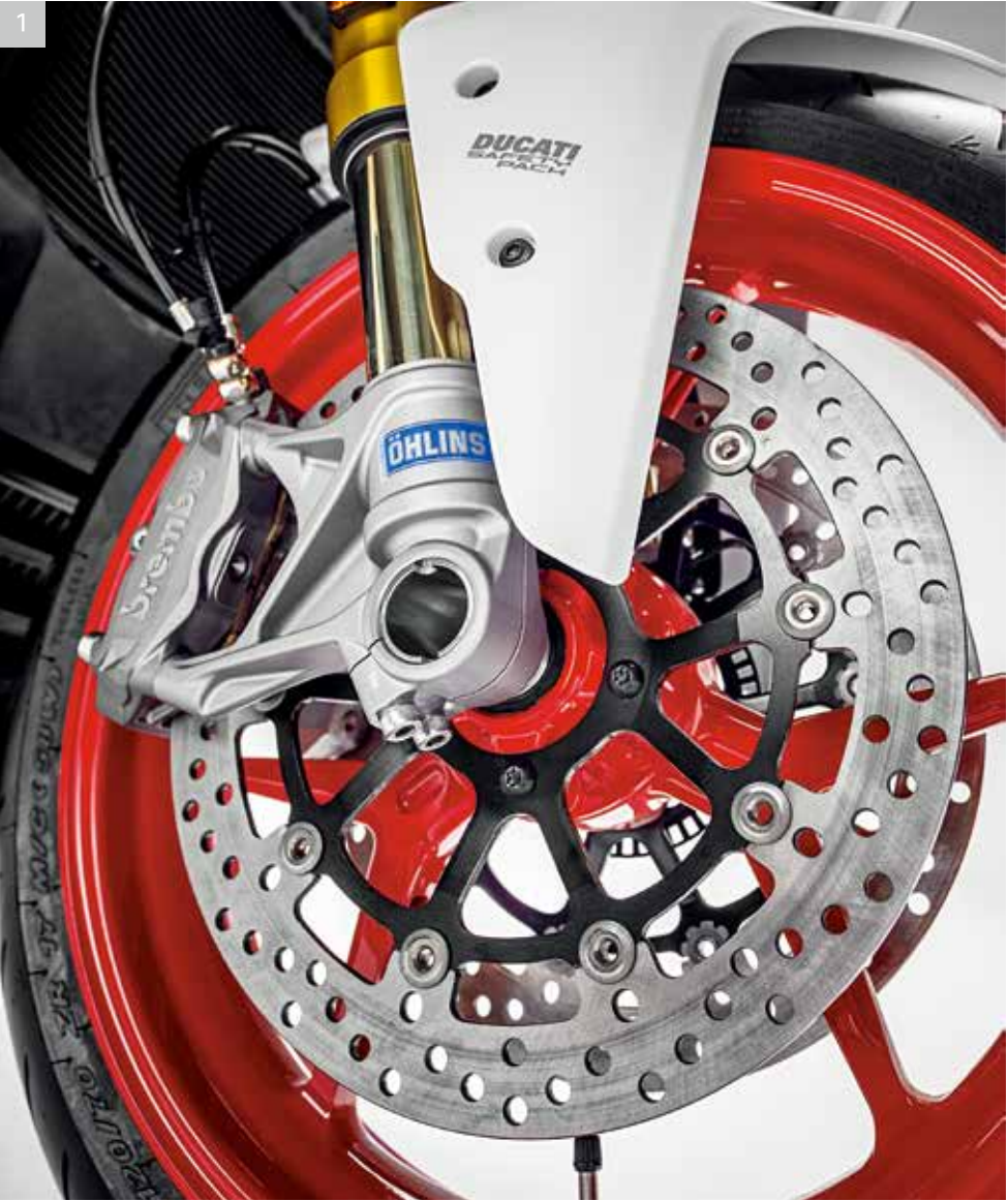
1 オーリンズ製フルアジャスタブル倒立フォーク、320mm径ダブルディスクとブレンボ製ラジアルマウント・モノブロックキャリパー
