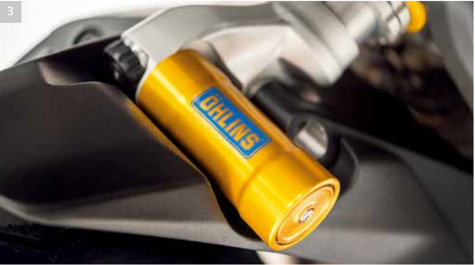
3 ガスリザーバータンクと一体化したオーリンズ製フルアジャスタブルモノショック
