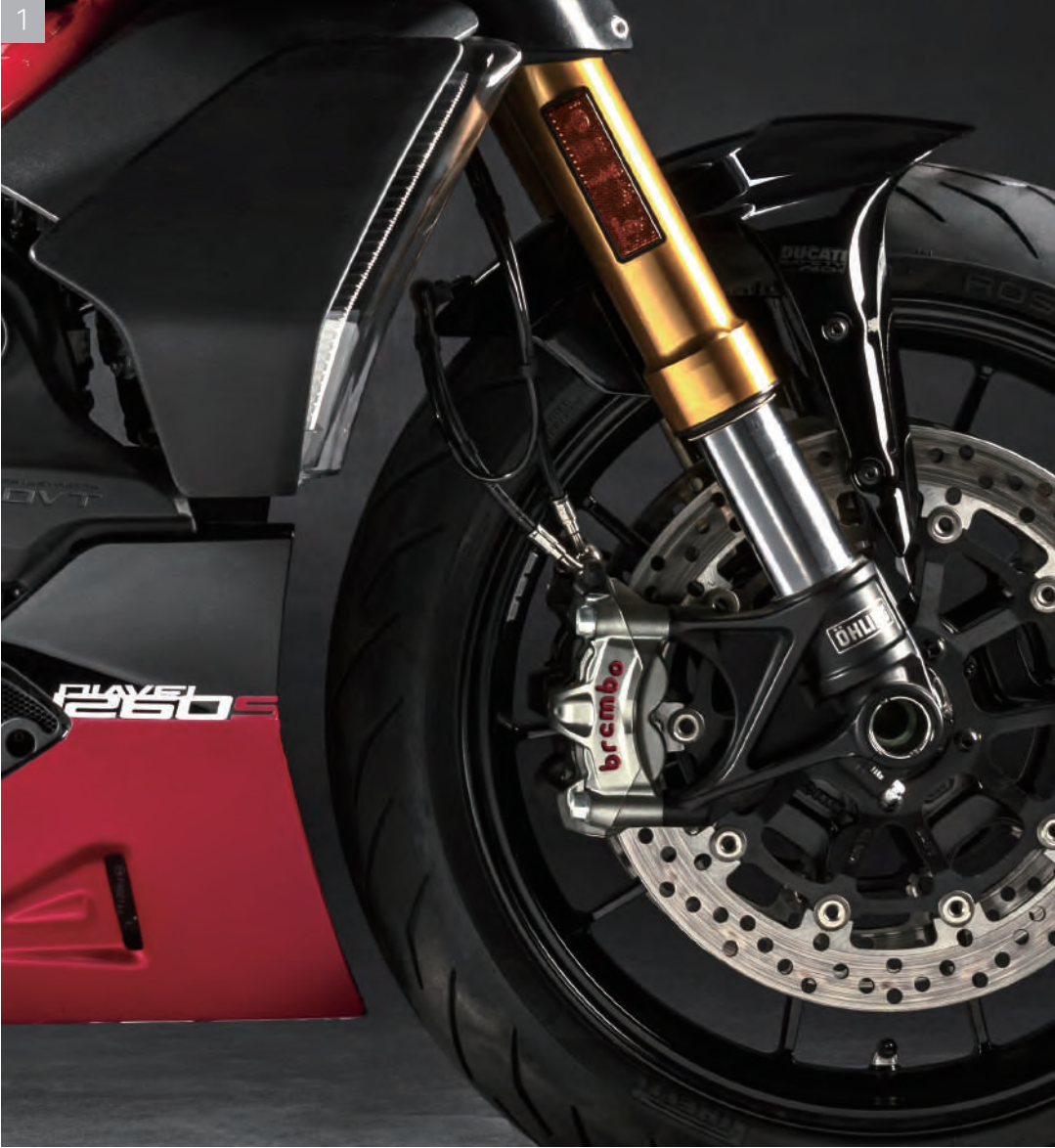
1 オーリンズ製フルアジャスタブル・フロントおよびリア・サスペンション(ゴールド仕上げ)
