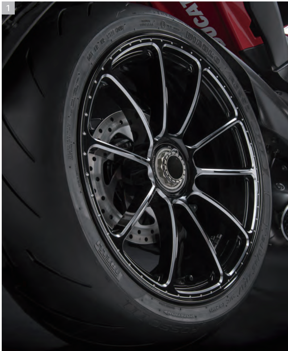
1 アルミニウム製鍛造ホイール
