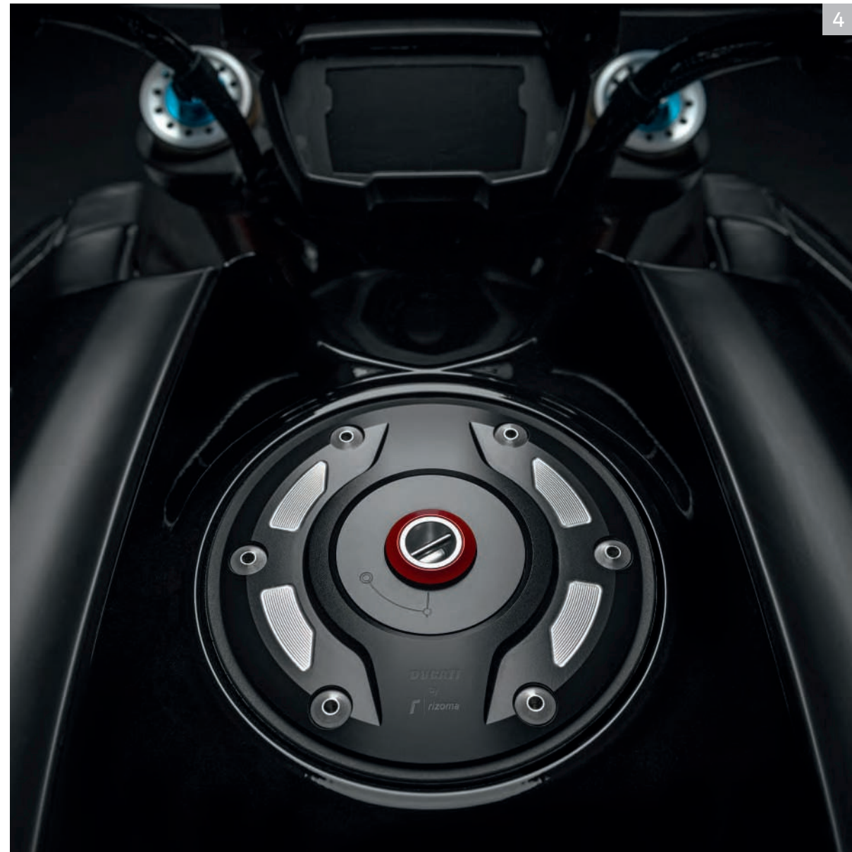
4 ビレット・アルミニウム製フィラープラグ
