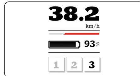
Im Bremsmodus wird der Akku aufgeladen und der dunkle Balken zeigt von links nach rechts.
