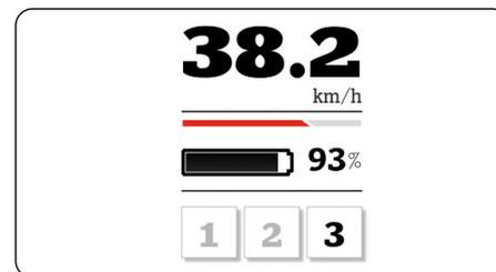
Zu Ihrer Sicherheit wird ein kleiner Teil der Akku-Energie gespart, damit die Grundfunktionen Ihres Stromers aufrechterhalten werden können. Licht und die Anzeige funktionieren, wenn der Akku leer ist und die Motorenunterstützung aussetzt, noch für rund eine Stunde weiter.
