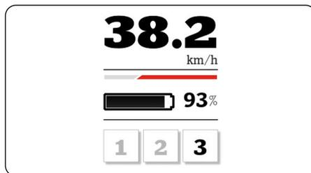
Im Bremsmodus wird der Akku aufgeladen und der Balken (in folgender Abb. rot) zeigt von links nach rechts.
