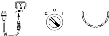
O instagrid ONE max está no modo de TRANSPORTE e a entrada de carregamento está ligada à rede. Espera-se que uma bateria de arranque vazia esteja completamente carregada após aprox. 5 horas.
