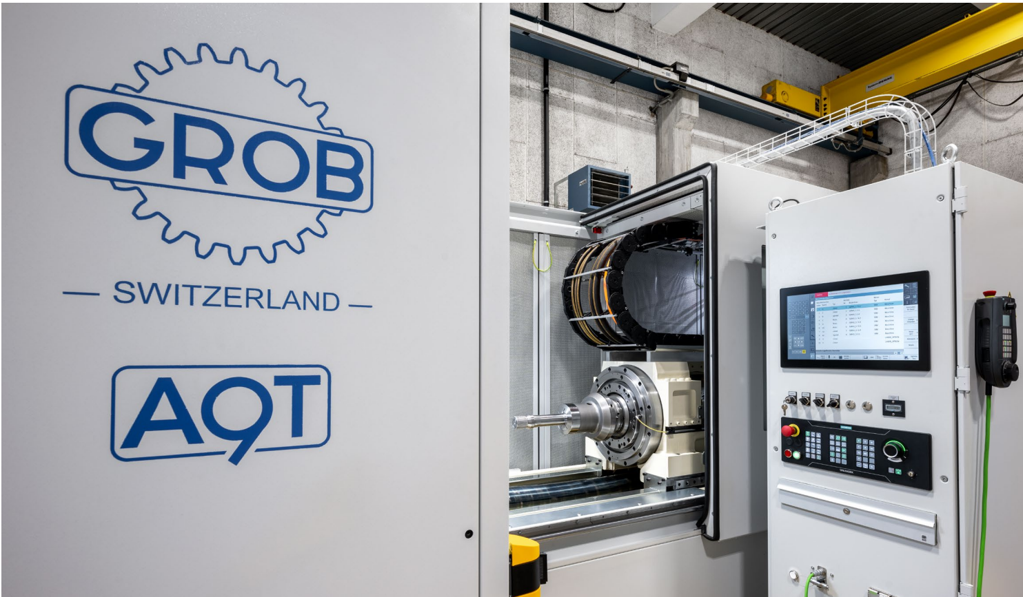
Auf der Maschine lassen sich Teile bis 120 mm Durchmesser bearbeiten. Die Massenträgheit der Bearbeitungsteile ermittelt die Steuerung mit dem «Auto-Servo-Tuning» automatisch.
