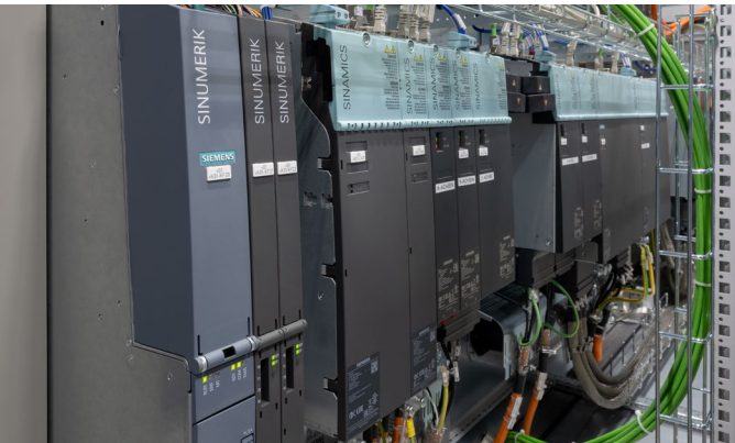
Bei Bedarf lässt sich die Steuerung der A-Serie-Kaltumformmaschine modular erweitern – zum Beispiel für zusätzliche Werkzeugachsen.
