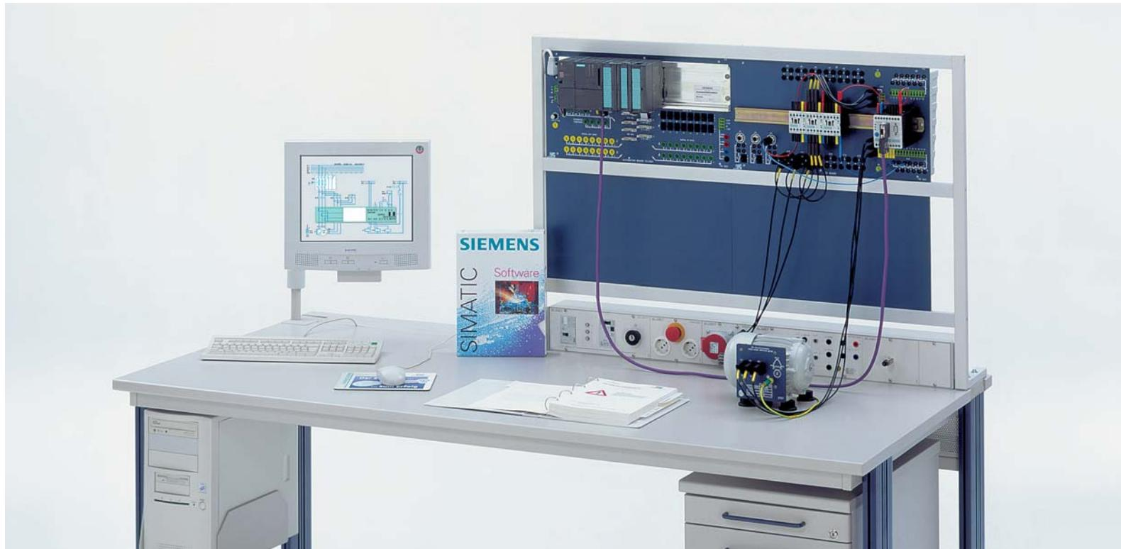
Einbindung eines Siemens Motorüberwachungsbausteins in ein PROFIBUS-DP-Netz.
