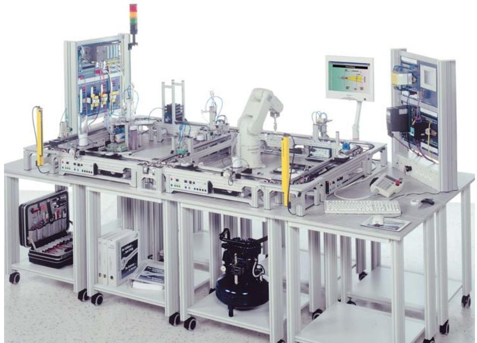
Vernetzte Transfersysteme mit unterschiedlichen Antriebs- und Steuerungskonzepten. Einsatz von Feldbusystemen. Motorsteuerung über PROFIBUS-DP und Sensorebene über AS-Interface.
