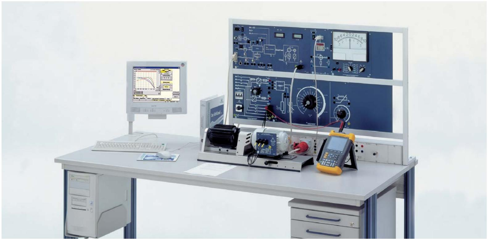
Universeller Belastungsprüfstand zur Inbetriebnahme und Kennlinienaufnahme von elektrischen Maschinen
