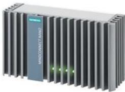
MindSphere Nano 是一种数据传输设备，能够和 MindSphere 连接。该设备被用于数据采集，支持多种通信协议。该设备通过安全的网络与 MindSphere 连接进行数据传输，使诸多基于云的应用和服务成为可能。MindSphere Nano 只能在和 MindSphere 连接的情形下使用。
