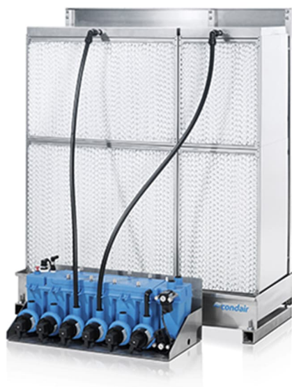
Fig. 5-10 Adiabater Befeuchter für adiabate Kühlung der Abluft (Quelle Condair)
