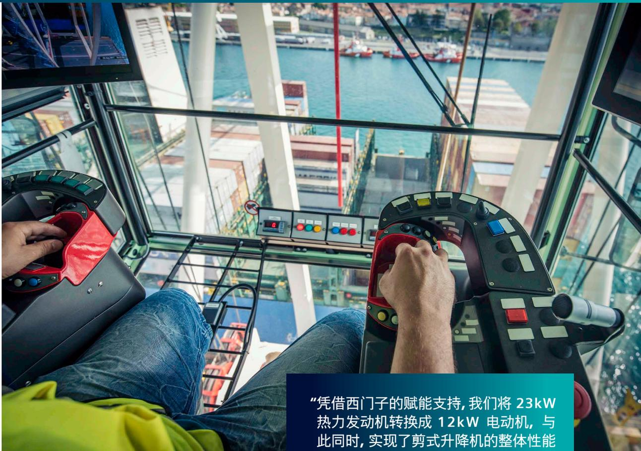
“凭借西门子的赋能支持，我们将 23kW 热力发动机转换成 12kW 电动机，与此同时，实现了剪式升降机的整体性能优化。”
