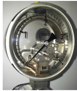
Fig. 4-31 Rohrfedermess-System Rohrfederanometer MAN-R (Fa. Kobold) Quelle: Wikimedia Commons, https://commons.wikimedia.org/wiki/File:Bourdon_tube_pressure_gauge_glass_front.jpg Messbereich: z.B. 0 ... 4 bar
