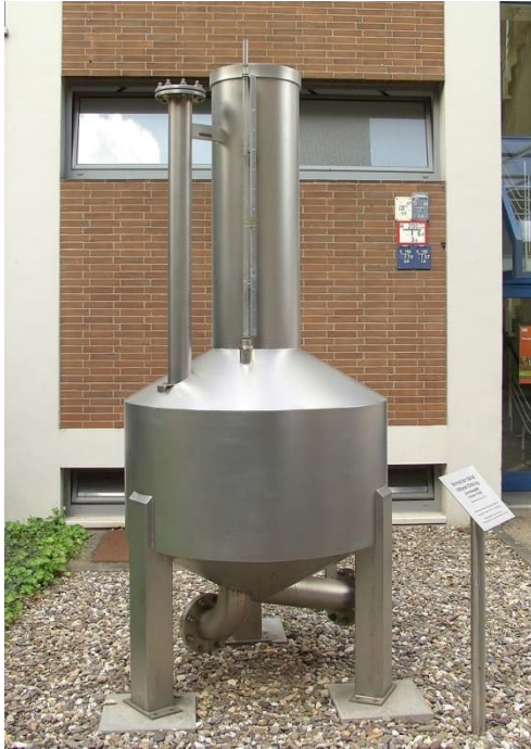
Fig. 1-2 Durchflusstandard für Wasserzähler bis DN100 (Quelle: © Raimond Spekking / CC BY-SA 4.0 (via Wikimedia Commons), Eich-Messgefäß - Normal der nächste höheren Ordnung (4513), CC BY-SA 4.0)
