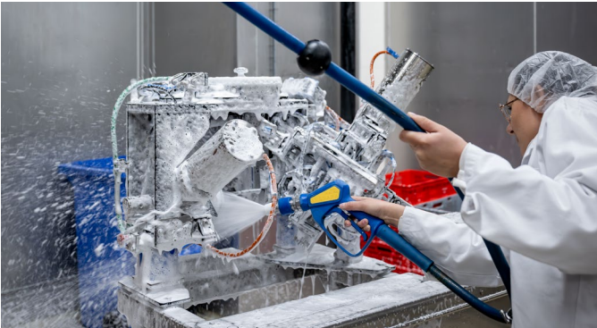
Flotte Reinigung: Die wasserdichte Greifeinheit lässt sich kräftig einschäumen, und die neuen Simotics-Edelstahlmotoren weisen keine Kanten auf, an denen Bakterien anhaften könnten.
