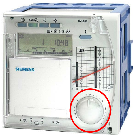
Fig. 3-4 Parallelverschiebung der Heizkennlinie mit Hilfe der Raumtemperatur-Korrektur mit einem Potentiometer für Komfort-Betrieb und Einstellparametern (Service-Ebene) für die Nachtabsenkung (vgl. Beispiel)
