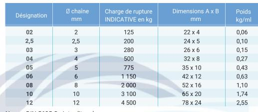
Norme DIN 5685 C - Interdit au levage - Non fabriquée en France
