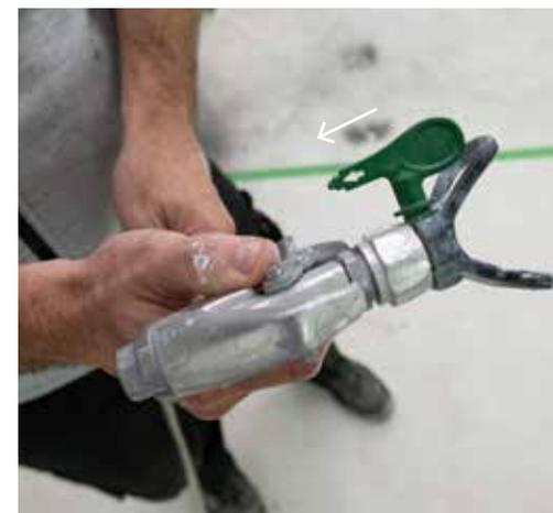
Il y a à ce moment encore de **l'eau dans la machine à pistoler et dans le tuyau**. Cela évite que les résidus de peinture ne sèchent dans le tuyau et dans la machine. Vous pouvez éventuellement mélanger cette eau avec du nettoyant Wagner Easyclean.
