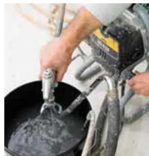
**3** Placez le bouton de fonction sur « Circulation ». Laissez l'eau/le solvant circuler dans la machine.
