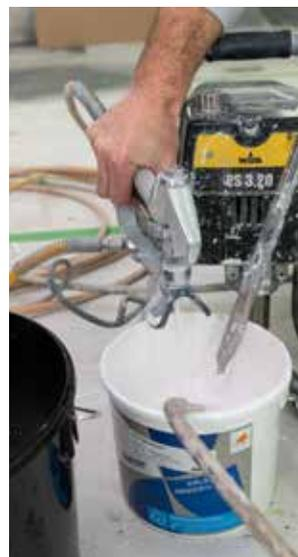
**7** Tenez à présent le pistolet au-dessus du seau de peinture. Appuyez sur la gâchette avant d'augmenter progressivement la pression. Maintenez la enfoncée pendant environ 30 secondes afin de purger tout l'air qui se trouve dans le tuyau, dans le pistolet et dans la machine et qu'il n'y ait plus que de la peinture qui sort du pistolet. Relâchez la gâchette du pistolet.
