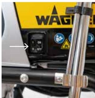
**1** En fonction du type de machine que vous possédez, utilisez l'interrupteur ou le bouton rotatif pour mettre la machine en marche.
