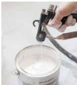
**2** Placez le bouton de fonction sur « Pistolage ». Récupérez la peinture restante dans le tuyau de peinture. Dirigez le pistolet perpendiculairement vers le bas dans le pot de peinture. Appuyez sur la gâchette du pistolet avant d'augmenter progressivement la pression. Procédez ainsi jusqu'à ce que la peinture sorte du pistolet.
