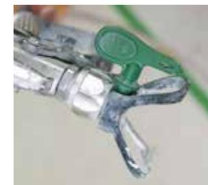
**8** Montez le gicleur (voir montage en page 26). La machine est prête à être utilisée pour le pistolage.
