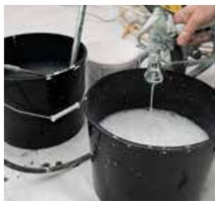
**9** Pistolez pendant quelques minutes jusqu'à ce que de l'eau sorte du tuyau et du pistolet. Diminuez à nouveau la pression et relâchez la gâchette du pistolet.
