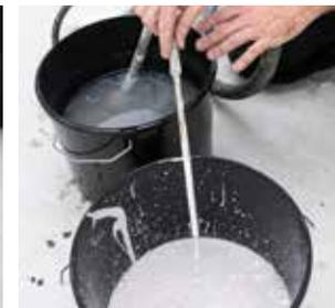
**2** Retirez le tuyau d'aspiration du seau de peinture et récupérez l'excédent de peinture avec un pinceau. Placez-le dans un seau rempli d'eau. Nettoyez le tuyau d'aspiration avec de l'eau.
