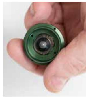
**1** Fixez le gicleur à l'envers. Replacez le chapeau d'air et la bague rotative sur le pistolet.
