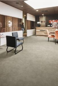
Vinyle en dalles ou planches avec une épaisseur de 3,15 mm, couche supérieure: 0.35 mm.
