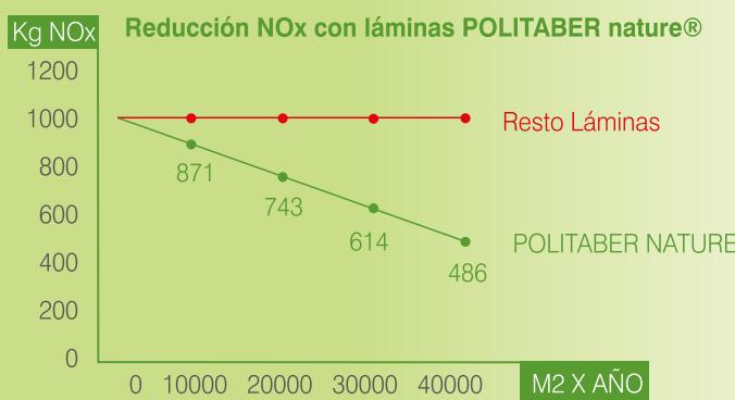
Para una cubierta de 2000 m<sup>2</sup> con lámina **POLITABER nature®**, durante 20 años de utilización, conseguimos eliminar 514 kg NOx de la atmósfera, equivalente a las emisiones de 33 coches durante 20 años, y al NOx suprimido por 780 m<sup>2</sup> de áreas verdes.
