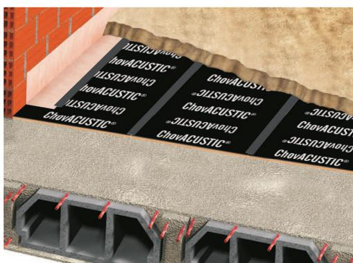
4- Por último, realizar la solera de mortero armada de al menos 50 mm de espesor. En cuanto a las dosificaciones y armado de la solera se seguirán las recomendaciones de la dirección facultativa.
