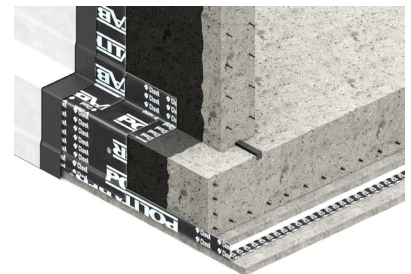
Protección de muro y placa de cimentación por el exterior del edificio
