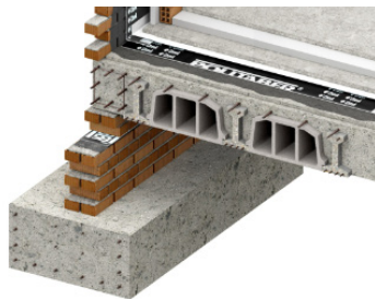
Protección de forjado sanitario por su cara superior
