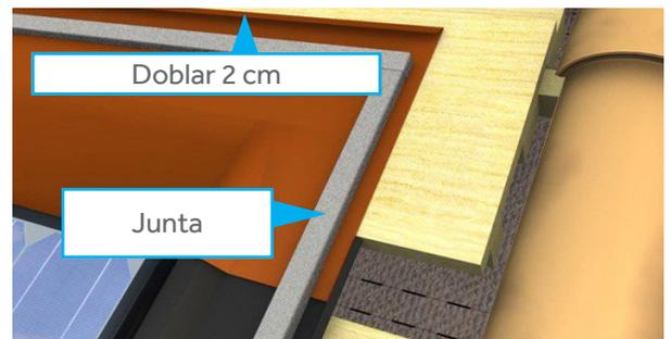
Realización de remate superior del conjunto con banda impermeable (Wakaflex)
