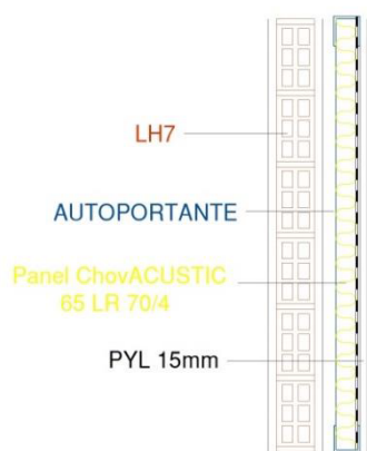
TRASDOSADO 7,3 cm de ESPESOR
