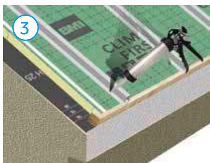
3. Sellado con adhesivo de poliuretano
