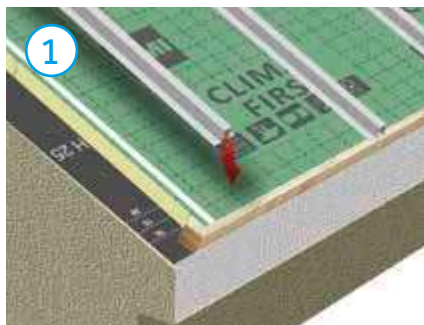
1. Replanteo rastrel primario (distancia 50 cm.)
