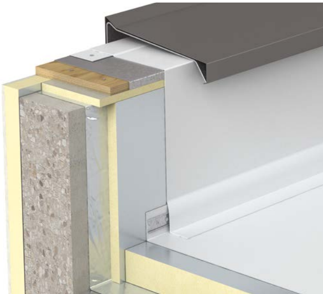
Figura 9. Paramento con vista detallada de la coronación metálica.
