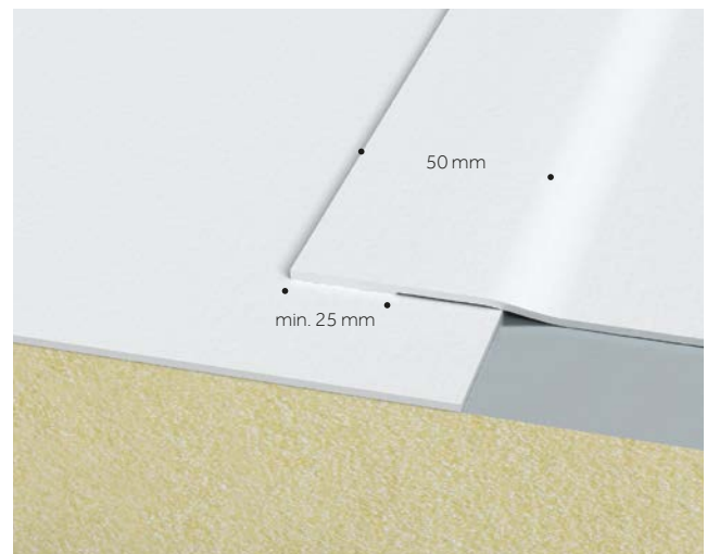
Ejemplo de soldadura de solape en final de rollo.
