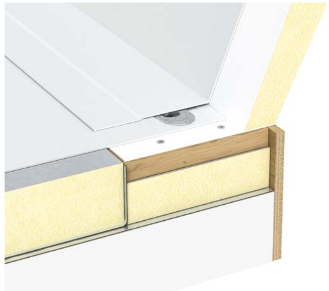
Figura 10. Acabado de la lámina con vista detallada del lucernario.
