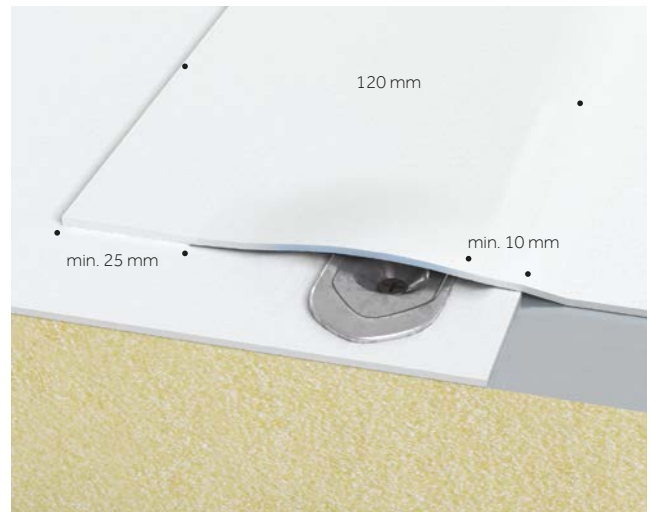
Ejemplo de revestimiento lateral con barra de fijación.
