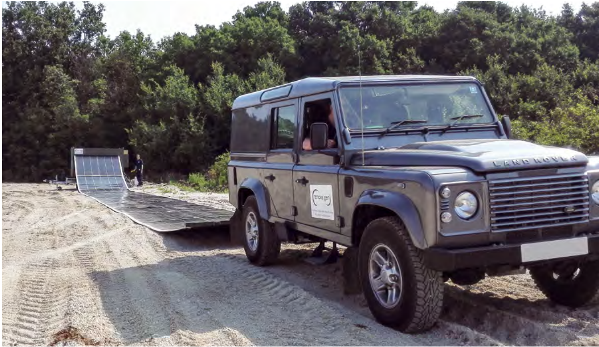
Abb. 25: Ausrollbare Photovoltaik Einheit für zeitweises Aufbringen auf Brachflächen oder Leestehenden Feldern.
