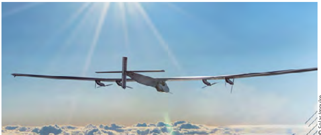
Abb. 12: Solar Impulse 2 mit Photovoltaik auf den Gleitflächen
