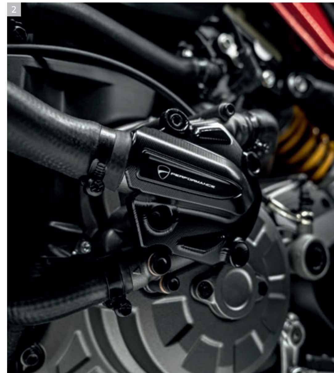
2 Cover pompe à eau en aluminium usiné dans la masse
