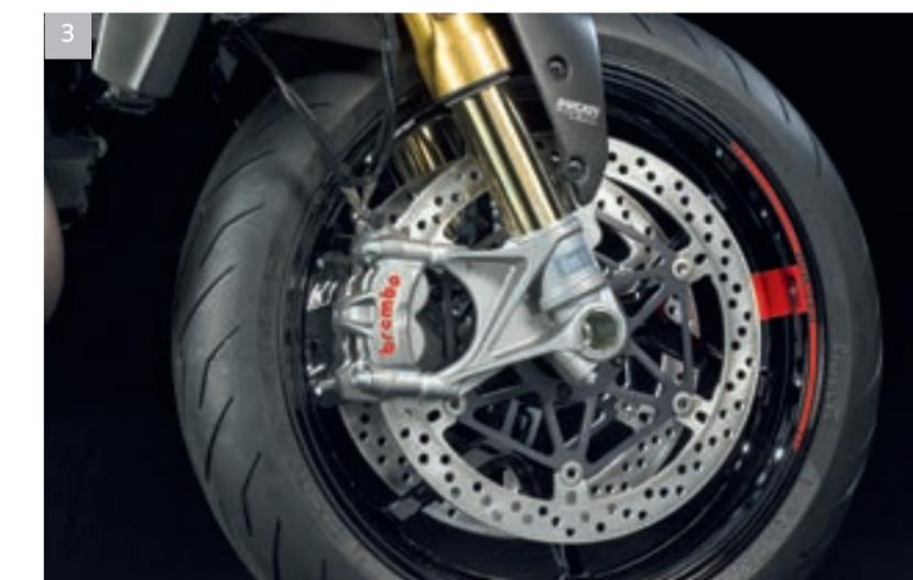
3 Frenos delanteros con discos de Ø 330 mm y pinzas Brembo monobloque M50 de anclaje radial
