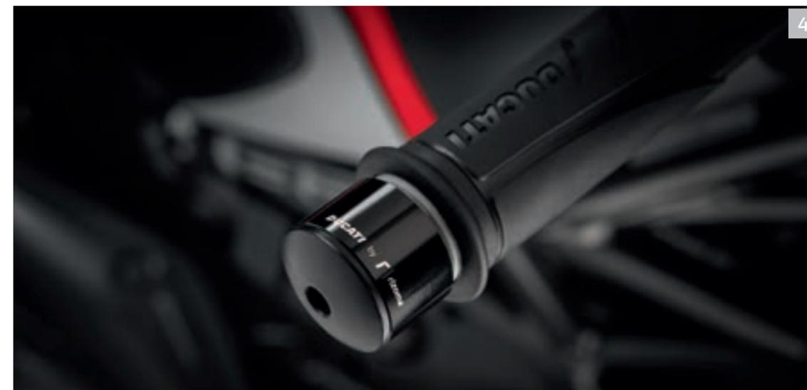
4 Contrepoids guidon en aluminium usiné dans la masse
