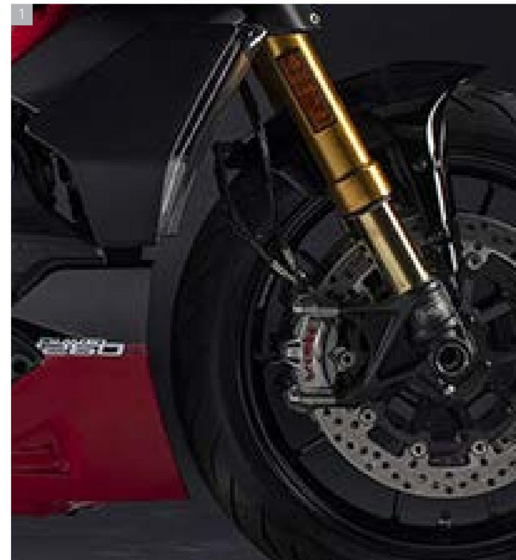
1 Suspensiones Öhlins con acabado dorado totalmente ajustable en la parte delantera y trasera
