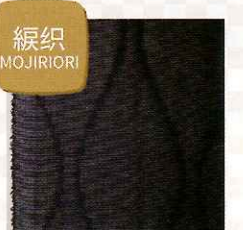
经线彼此交错, 同时编织纬线, 形成织眼有缝隙的织品。
