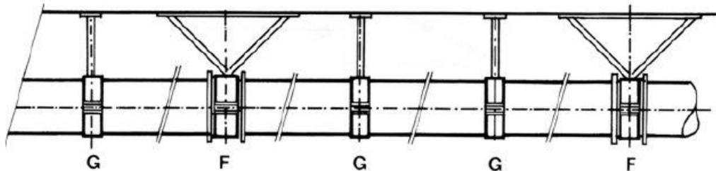
Die Gleitschelle muss gegenüber dem Rohr Spiel aufweisen, damit die Dehnung des Durchmessers nicht behindert wird. Der Innendurchmesser der Gleitschelle muss demnach 2% grösser als der Rohraussendurchmesser sein, sie darf durch die Spannschrauben nicht weiter schliessen. Jede dritte Gleitschelle ist quer zur Rohrachse abzustützen.
