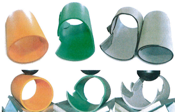
Bild 4: Probekörper nach/beim Fallschlagtest
