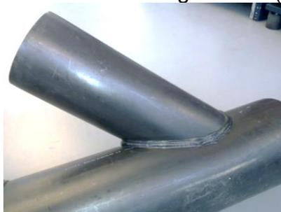
Extrusionsgeschweisster 45° Abzweig aus PE
