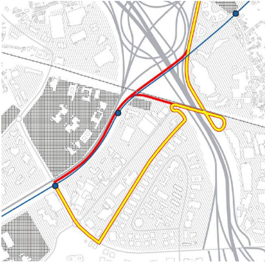
Figuur 103. Fietstraject over R0: route via nieuw fietstraject parallel aan Kouterveldstraat en oversteek R0 via fietssnelweg langs spoorwegbrug
