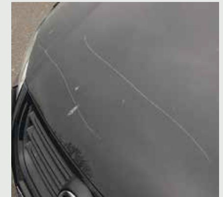
Beschädigung des Basislacks
