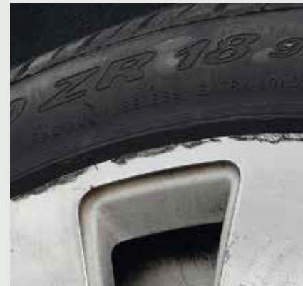
Beschädigung Felgenhorn mit Materialabtragung
