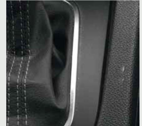
Geringfügige Beschädigung der Kunststoffverkleidung
