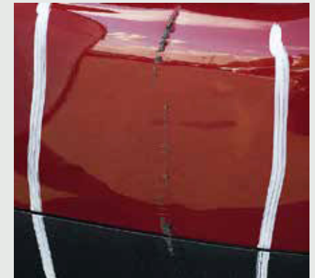
Deformation der Stoßfängerverkleidung
