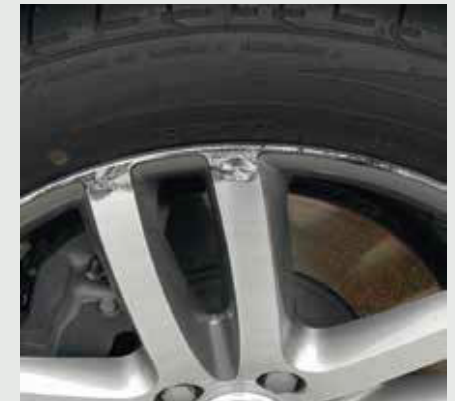
Materialabtragung an der Felge
