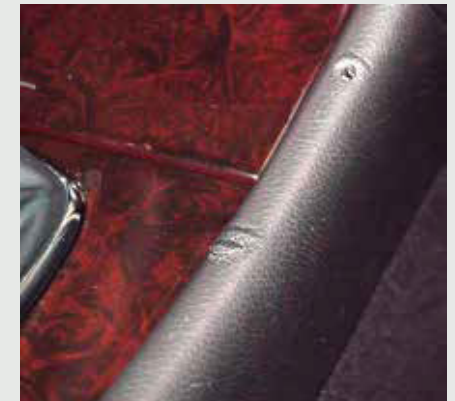
Verformung in der Kunststoffverkleidung
