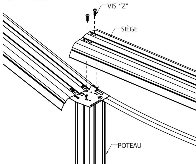
Maintenez les sièges en place à l'aide de quatre (4) vis "Z".
