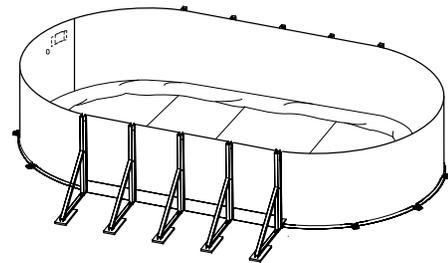
Amenez la toile par-dessus le sommet du mur en laissant excéder entre 10 cm à 15 cm (4" à 6") à l'extérieur du mur. Maintenez ensuite la toile en place, à l'aide d'un coupleur de plastique (pas inclus). Installez la rainure du haut sur le mur et installez la plaque du haut sur chacun des montants verticaux.
