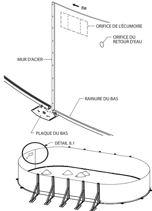
Joindre les bouts du mur en orientant les plis vers l'extérieur de façon à cacher l'icône d'exclamation. (voir l'illustration 8.1) **Note: Si le mur est joint correctement, vous ne devriez plus voir l'icône d'exclamation. Si vous pouvez toujours voir l'icône, vous devez inverser le chevauchement.**
