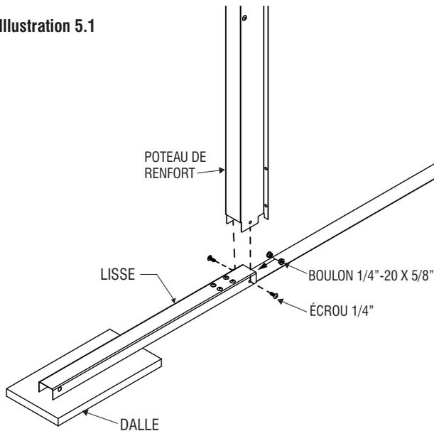
Fixez ensuite l'autre extrémité des étais aux poteaux de renfort à l'aide de deux (2) boulons et écrous 1/4" #20 X 5/8" (6,35 mm X 15,88 mm).
