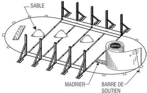
Insérez le mur d'acier dans la rainure du bas en commençant au centre d'une plaque du bas. Au départ, une ou deux barres de soutien maintiennent le mur en place. Une personne déroule le mur d'acier sur un madrier ou une planche, tandis qu'une autre personne l'insère dans la rainure du bas. On ne doit pas dérouler plus de 3 m (10') sans mettre en place une barre de soutien pour renforcer la structure.
