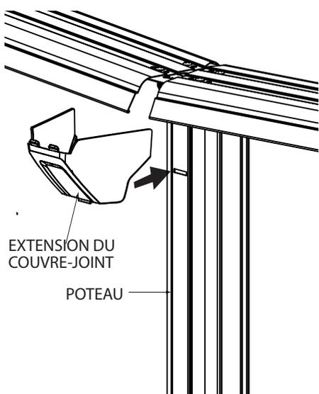
Pivotez le couvre-joint sur les sièges jusqu'à ce qu'il s'enclenche sur la bordure intérieure des sièges.
