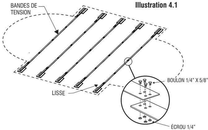
**3) Se référer à l'illustration 4.2:** Fixez les bandes de tension ainsi assemblées aux lisses des deux côtés, à l'aide de quatre (4) boulons et écrous (BB) 1/4" #20 X 5/8" (6,35 mm X 15,88 mm).
