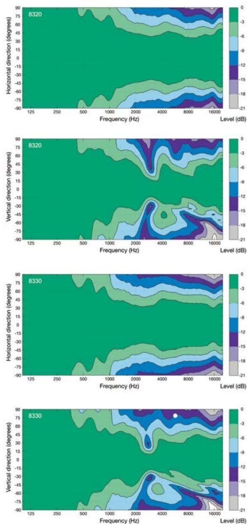
图 4: 8320A 和 8330A 的水平面与垂直面指向特性。
